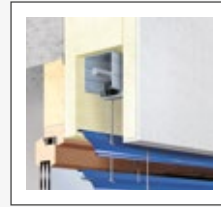
Montage dans le linteau
