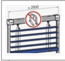
Construction de stores autoporteuse
